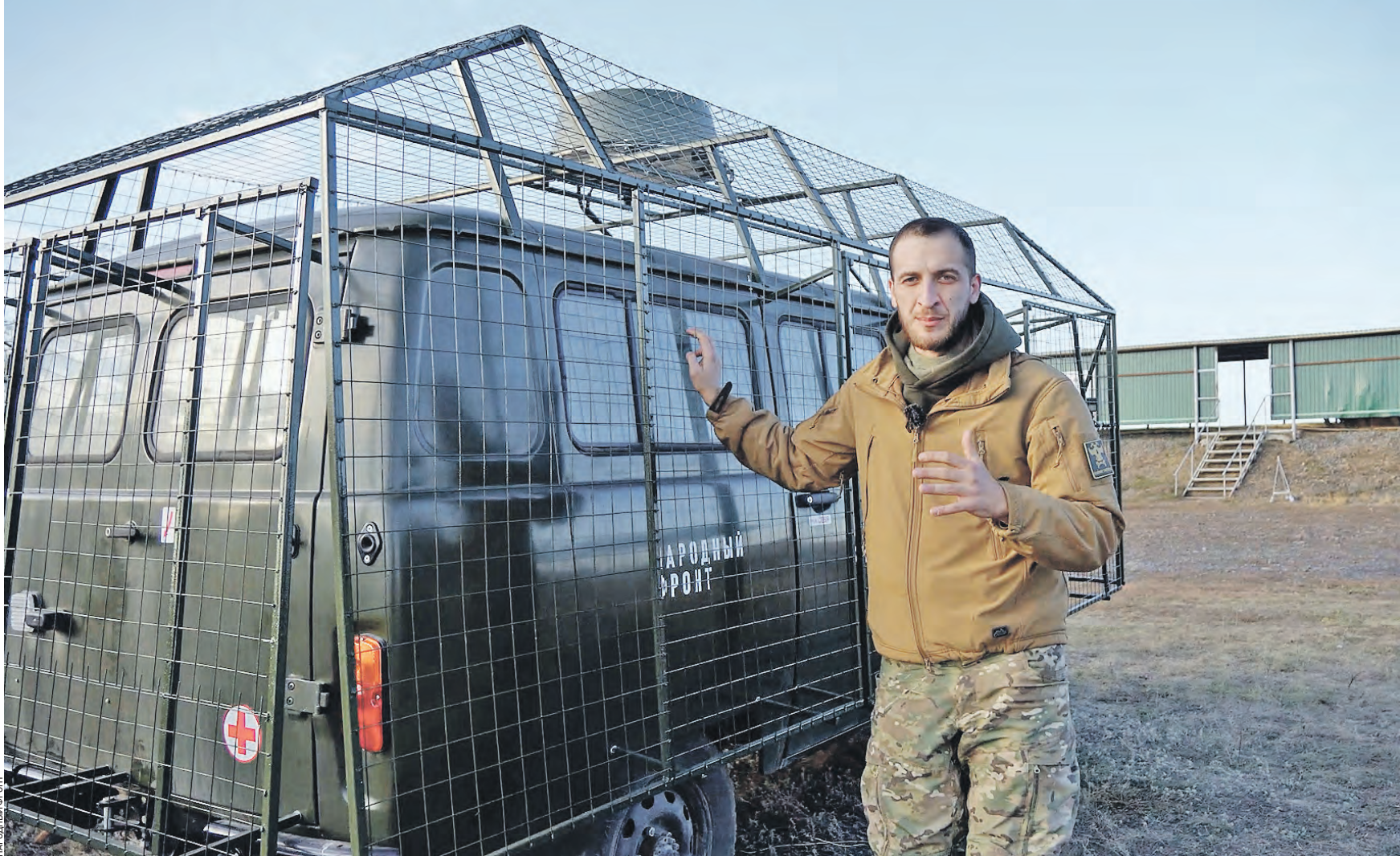
26 октября. Участник испытания обновленной эвакуационной техники, доброволец, боец Георгий Мамсуров. В ходе теста был проверен новый комплекс защиты, который включает в себя антитанковый «мангал» и противоскользящее одеяло
